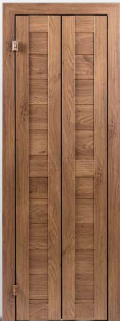
Doghe orizzontali con passo 120 mm circa incastonate nella struttura perimetrale dell'anta e delle traversine orizzontali.
